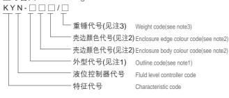
注1(外形代号): "1"-斜方"2"-长方"3"-大圆"4"-小圆"5"-椭圆注2(颜色代号): "R"-红色"Y"-黄色"S"-蓝色"G"-灰色"B"-黑色
